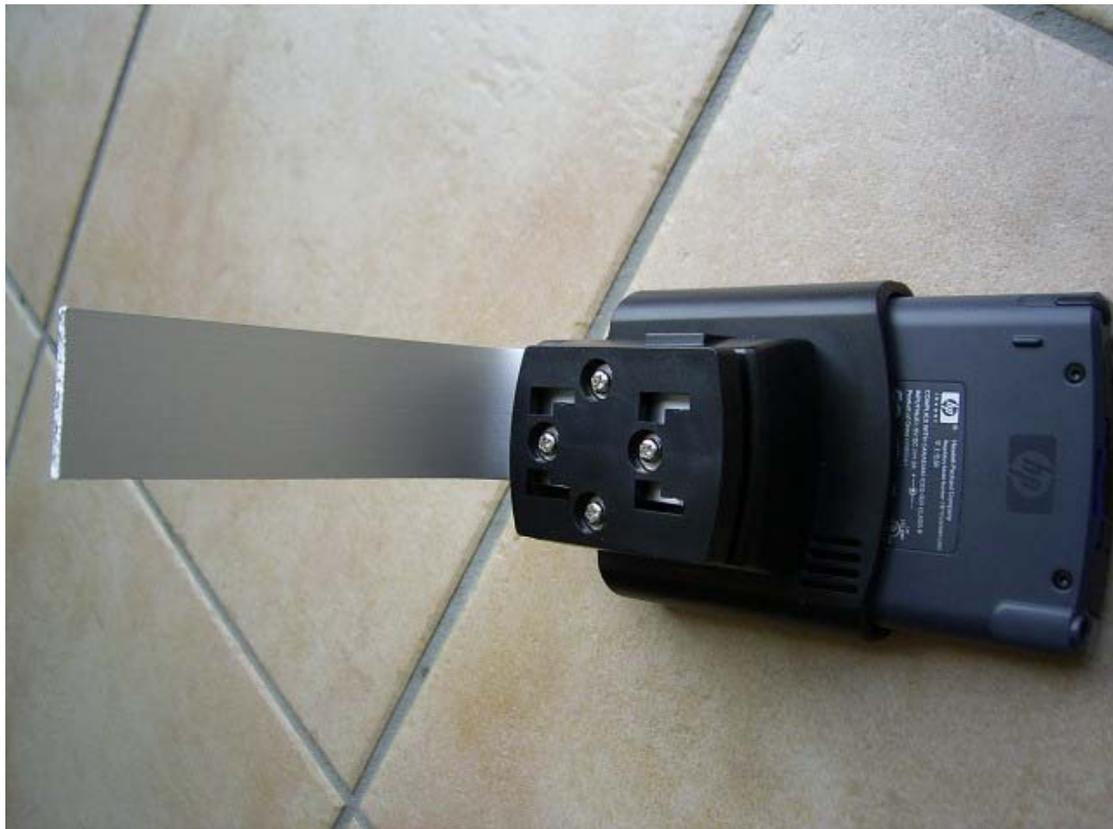
Mit einer Konterleiste kann der Halter dann an dem Ablagefach befestigt werden, ohne dieses zu beschädigen, da das Ablagefach sozusagen durch die beiden Aluleisten nur eingeklemmt wird. Bohrungen müssen natürlich an den Leisten übereinstimmen.
