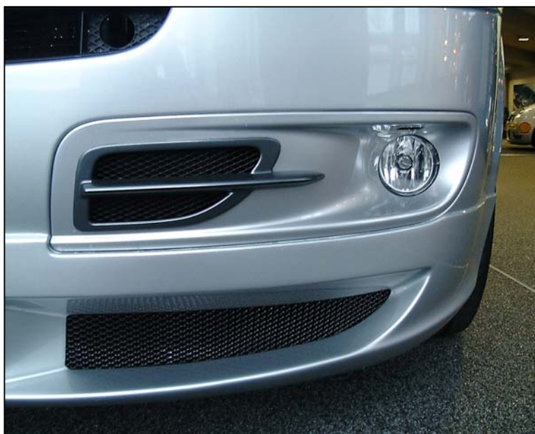
Abb.3: Detailansicht einer montierten Abt Nebelscheinwerferblende
