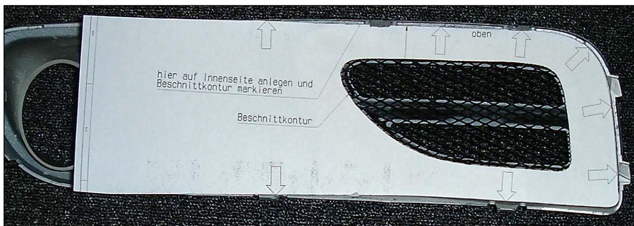
Abb.1: Anlegen der ausgeschnittenen Schnittschablone
