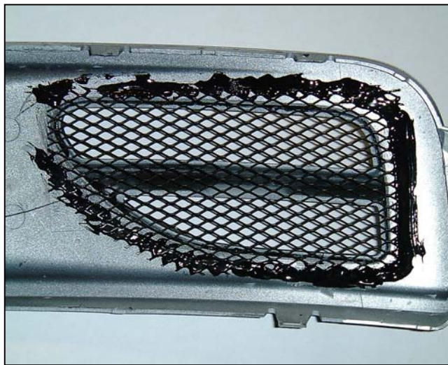
Abb.2: Befestigen des zugeschnittenen Gitters
