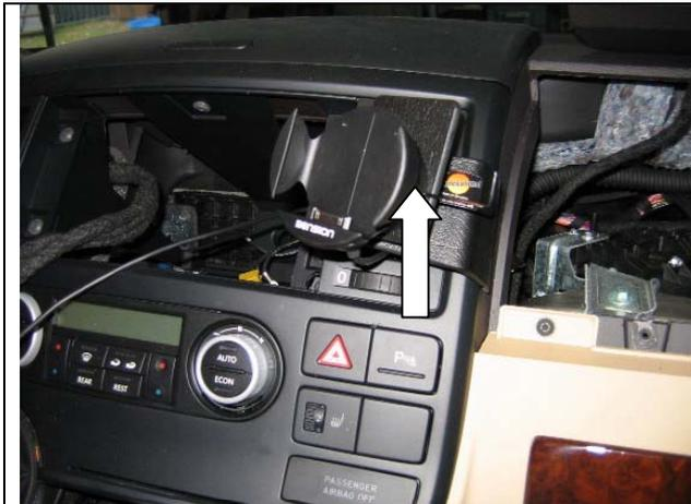
iPod-Cradle auf dem Grundhalter aufsetzen und mit dem mitgelieferten kleinen Inbusschlüssel festziehen.
