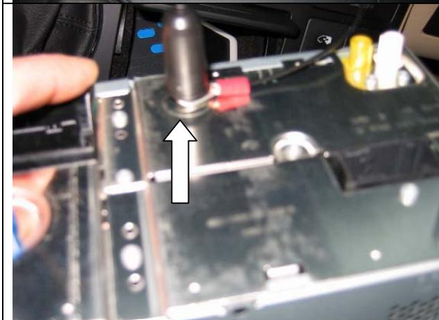
Ringöse am schwarzen Massekabel des Ice-Links ancrimpen, schwarze Kunststoffführung an der Rückseite des Navigationsgerätes abschrauben und zusammen mit der Ringöse des Massekabels wieder aufschrauben.
