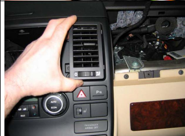
Handschuhkasten entfernen (4 Torx-Schrauben ausdrehen) und Lüftungsdüse rechts neben dem Radioschacht herausdrücken.
