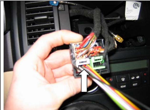
Stecker des Ice-Link Anschlusskabels in den freien Teil des Gerätesteckers einstecken.
