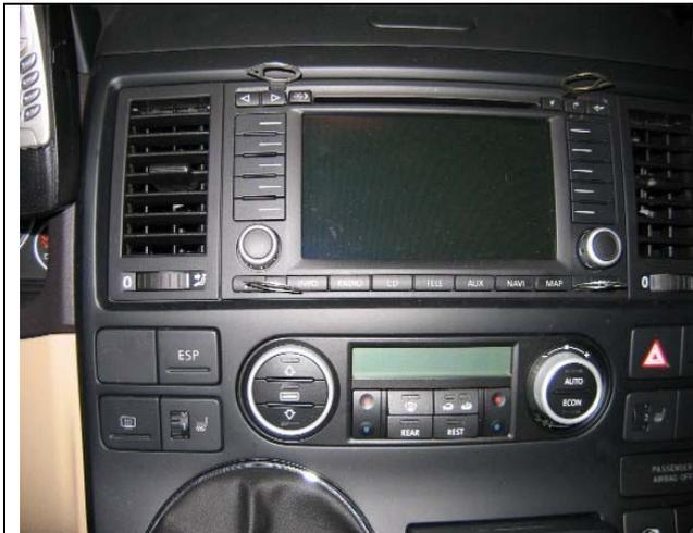
**Navigationsgerät mittels 4 Demontage-Haken entriegeln.....**
