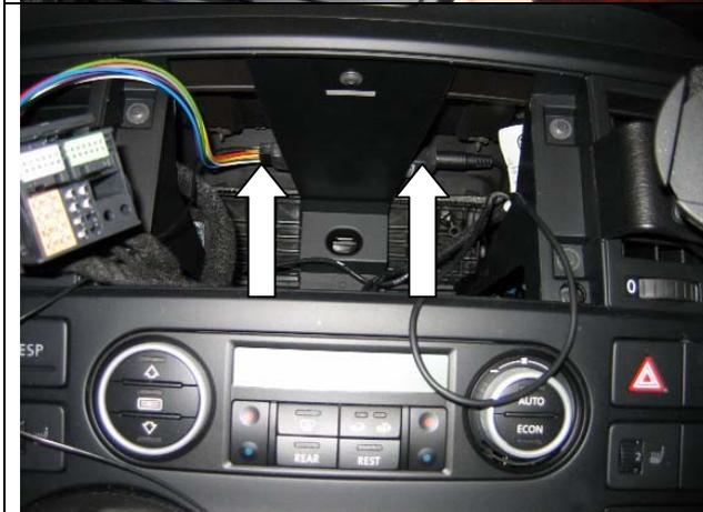
Kabel des Cradle am der Interface-Platine des Ice-Links anstecken und Interface-Platine mittels doppelseitigem Klebeband auf der Strebe oben im Radioschacht befestigen.
