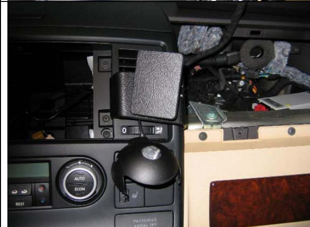
Lüftungsdüse zusammen mit dem Brodit-Pro-Clip einsetzen.
