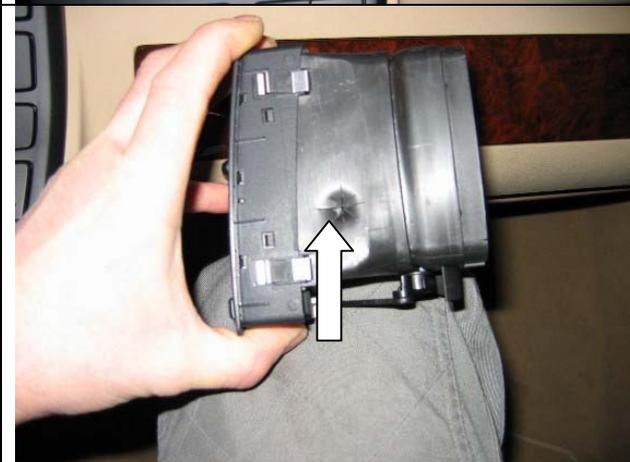
Um die Kabelführung möglichst unsichtbar vorzunehmen kann das Kabel durch die Lüftungsdüse geführt werden. Dazu seitlich in die Lüftungsdüse ein Loch bohren oder mit einem scharfen Messer einschneiden.
