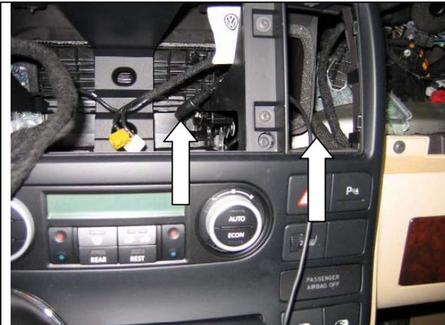
Kabel durch den Ausschnitt der Lüftungsdüse in den Radioschacht führen.
