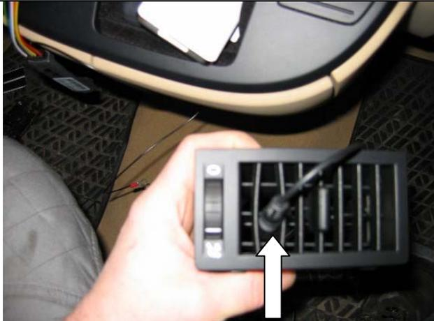
Den kleinen runden Stecker des Kabels vom iPod-Cradle vorsichtig durch die Lamellen der Lüftungsdüse schieben.....
